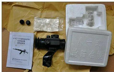
不过对它的差评也是挺多的：该瞄准镜没有采用开普勒瞄准系统，镜筒内没有棱镜组，因此结构简单、廉价且便于制造。而同样是因为没能采用开普勒瞄准系统，导致在通过瞄准具观测目标物体时，目标物体会变形，视场也狭小至极。物镜因为镀膜而导致偏橙红色，容易反光；目镜同样是因为镀膜工艺而导致观测物体泛青蓝色。
