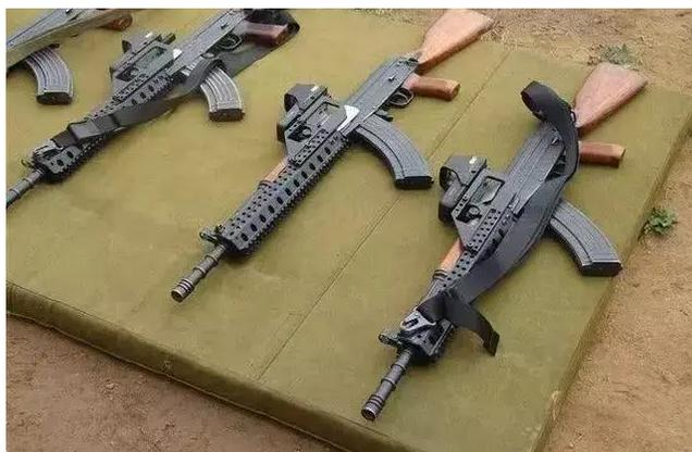
护木套带有极长行程的皮卡汀尼导轨
